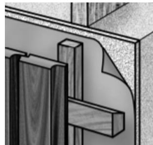
Afbeelding 6 - Afgeschuinde achterregel (Bron: Centrum Hout, 2018)
