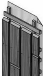
Afbeelding 4 - Verticale open gevelbekleding (Bron: Centrum Hout, 2018)
